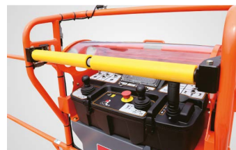
Устройство защиты от зажатия оператора
