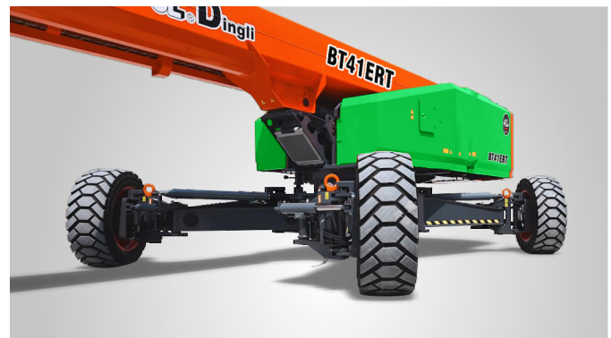
Совершенно новая технология выдвижения мостов одной кнопкой на месте эксплуатации. Глобальная патентная защита
